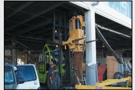
APE производит самые большие гидромолоты в США. Эти молоты работают на самых мощных насосных станциях, используемых в наших вибропогружателях. Эти молоты сочетают технологии, позволяющие не использовать громоздкие насосные станции и кабины управления, но при этом обеспечивают значительную силу удара. Ограничение хода ударной части осуществляется с помощью опционного счетчика ударов и отображения величины энергии удара.
