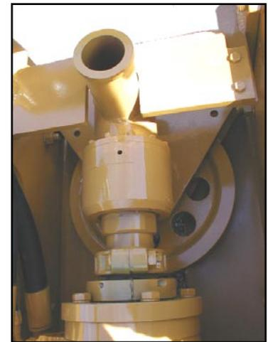
вертлюг APE/King выдерживает большее давление, чем другие модели. Сменные сильноизнашиваемые части и уплотнения делают стоимость ремонта низкой
